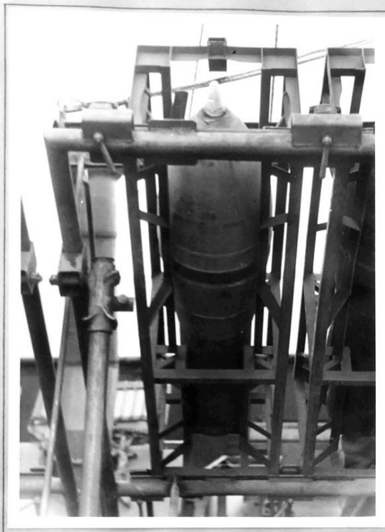
Abb. 2: 30 cm WK Spr. 42 im Packgefäß auf dem Wurffrahmen montiert..
