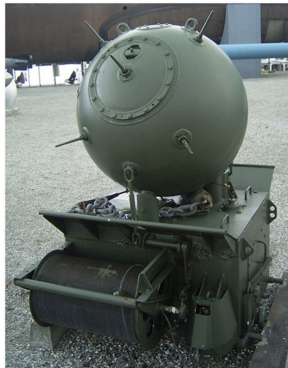
Fig. 2. Chemisch wirkender Zünder des Kontakt- L. Torpedos.
